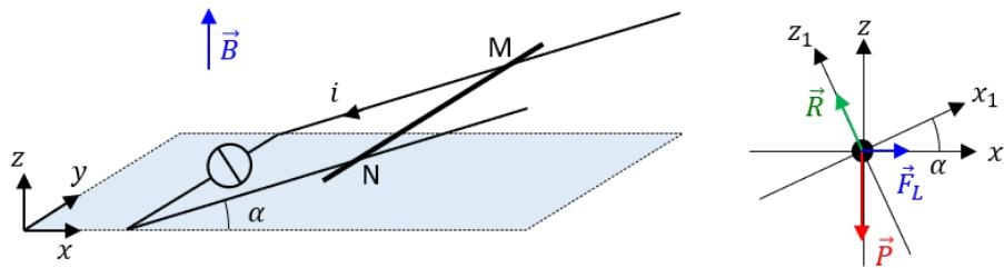
2) Bilan des forces dans la base  $(x_1, z_1)$  : poids, réaction normale du support et force de Laplace.
